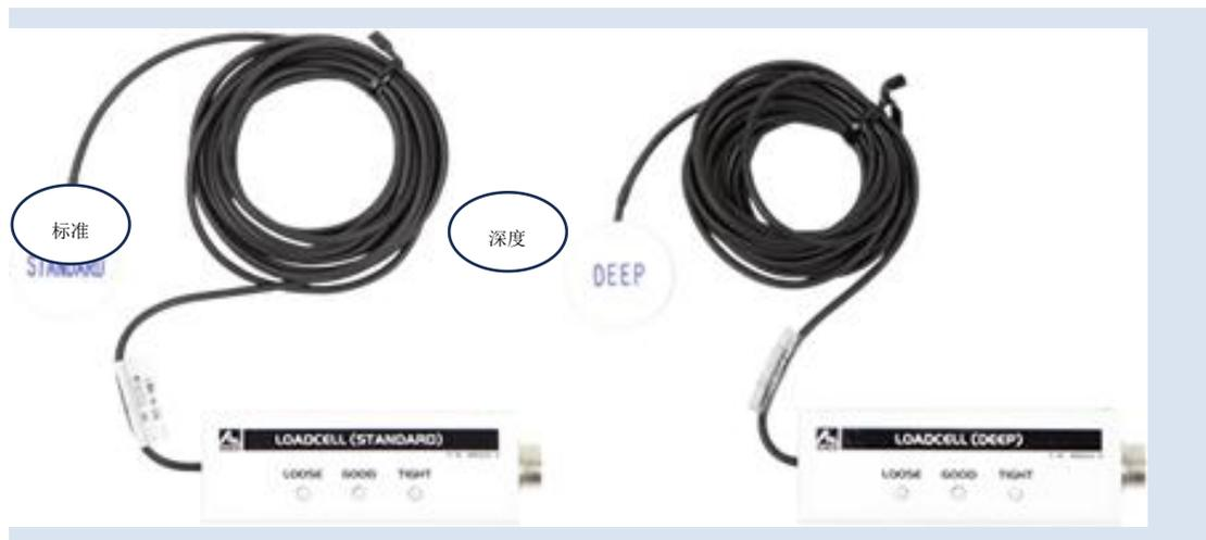
这是一种利用应变计检测压力的传感器。用负载单元固定带将传感器固定在患者身上，呼吸运动引起的体表运动（腹压变化）将以呼吸波形的形式显示出来。根据腹部运动的大小选用“深度”和“标准”两种不同模式。标准运动使用“标准”模式，大幅度运动使用“深度”模式。该组合模式非常适合允许患者进入机架深处的 PET-CT 设备。
