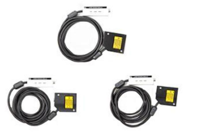
这是一种测距激光（红外线）反射的传感器。将激光束照射到患者的皮肤上，因呼吸运动而产生的体表运动（传感器的位移量）就会显示为呼吸波形。根据激光的焦距，该设备有 250mm、120mm 和 85mm 三种类型激光传感器。这种传感器不需要与患者接触。十分适合作为与放射治疗设备结合的模式。
